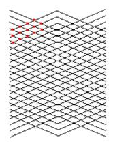
Для сопротивления давлению теплоносителей паяные теплообменники, помимо пайки по контуру пластин, дополнительно пропаяны во всех указанных точках. Таким образом, увеличивается рабочий диапазон давлений, который может достигать 40-45 бар.
