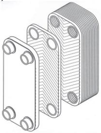
У соседних пластин углы между гофрами направлены в противоположные стороны. Точки, в которых стенки гофров соприкасаются, играют роль опорных точек для пакета пластин. Несколько таких точек выделены красным цветом на схеме:
